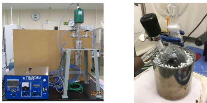
図 1: 試料重水素化装置 Parr Reactor(左)及び簡易重水素化器具(右)。
