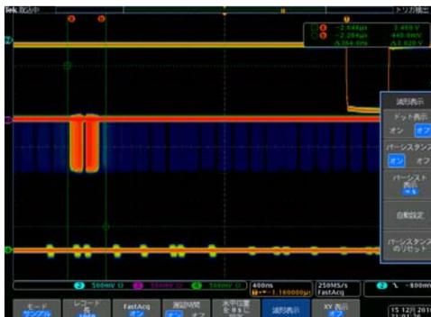
図 2 MB 運転時の光透過。開口時間はほぼ 360ns である
