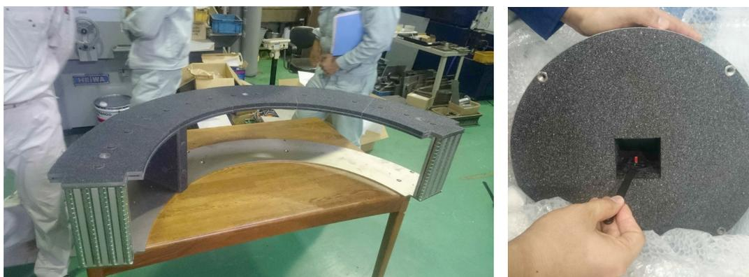
図 1 (左) 試料-アナライザー間の扇形ガイド磁場。(右) 試料上流に設置する縦磁場ガイドマグネット入り  $B_4C$  遮蔽体。差し込んでいるのは小型磁石で、縦磁場がかかっていることを確認した。
