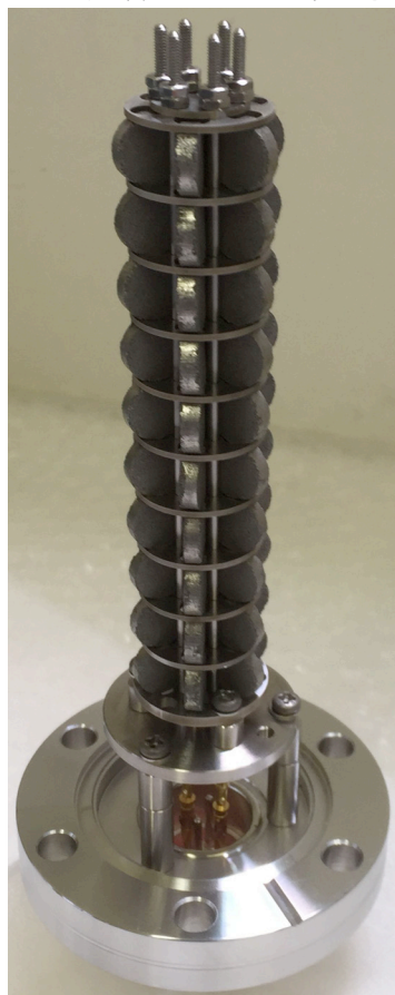
図 1. ICF70 NEG ポンプ。 図 2. オリフィス法に基づく排気速度測定装置。
